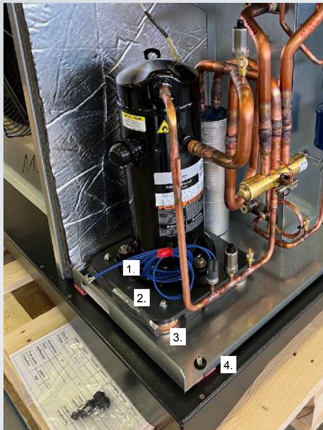
Pohlcování vibrací kompresoru prostřednictvím těžké podložky a silentbloků
